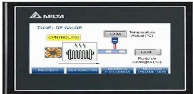
Figura 15. Interfaz Túnel de calor
