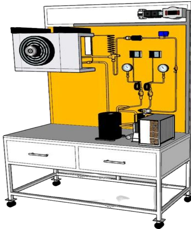
Figura 9. Diseño de la estación de entrenamiento de automatización y control
