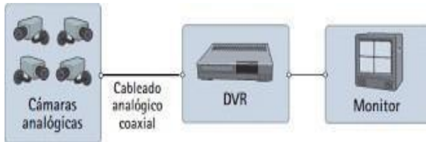
Figura 3. Sistema de circuito cerrado de televisión analógico con DVR.
