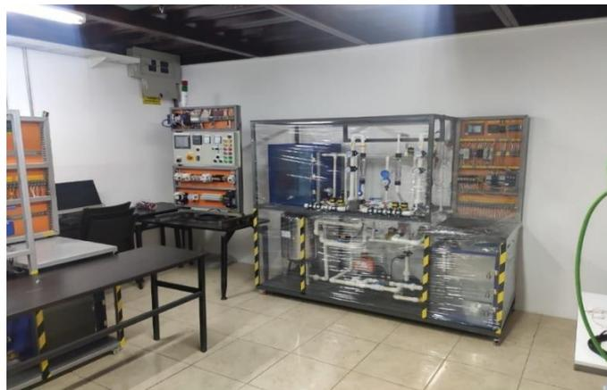
**Figura 3.** Módulo de entrenamiento profesional de instrumentación industrial
